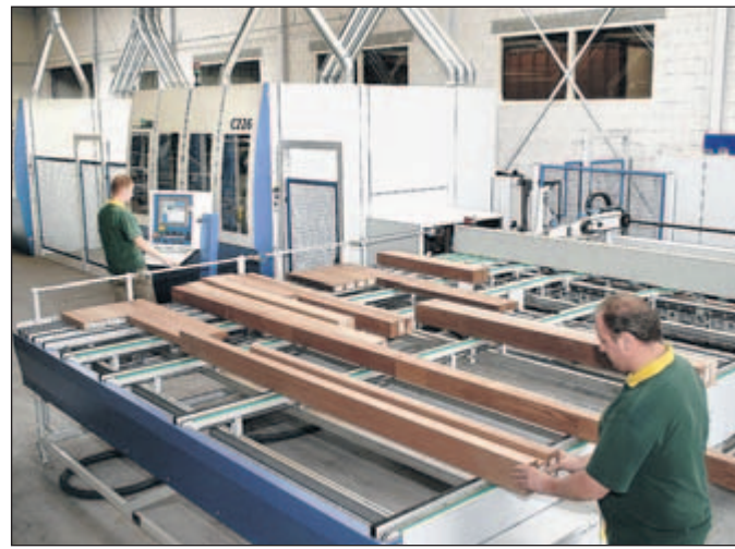
Met slechts een paar man personeel kan de volautomatische machinestraat wel 800 kozijnen per dag produceren.
